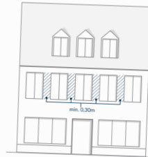
Abbildung 14: Einzuhaltende Abstände zwischen den Fassadenöffnungen
